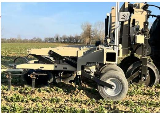
Les bineuses Binнове, fabriquées à la carte en France, se distinguent par leur grand dégagement sous châssis de 75 cm, leur robustesse, un entretien facilité sans graissage nécessaire sur la machine, mais surtout par leur parallélogramme inversé qui est unique sur le marché car breveté. En
