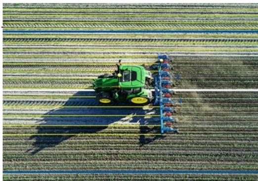
Grâce à une antenne sur le semoir, les lignes de semis sont cartographiées précisément grâce au RTK. Ces lignes de semis virtuelles serviront de référence pour les passages suivants, prenant en compte toute déviation ayant pu survenir au semis. Les électrodistributeurs du tracteur 6R ou 6M
