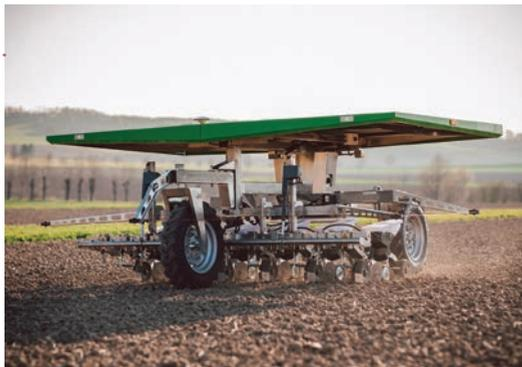
Le robot Farmdroïd FD20 est le premier robot entièrement automatique au monde capable de prendre en charge à la fois le semis et le désherbage mécanique des mauvaises herbes. Réduction des coûts de semis et de désherbage tout en le faisant de manière neutre en CO<sub>2</sub>. Il est alimenté
