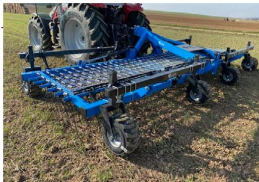
La herse étrille Sigma 6 m possède 6 rangées de dents d'un diamètre de 7 mm indépendantes à écartement régulier de 25 mm entre elles. Le réglage en continu depuis le tracteur permet une pression des dents allant de 0,5 kg à 5 kg ainsi qu'une intervention précoce à tardive. Un réglage
