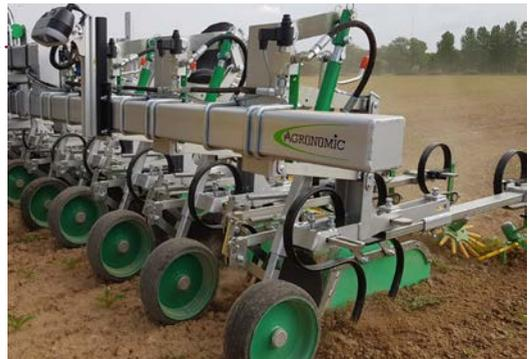
Bineuse autoguidée par trace et caméra disposant d'un châssis compensatoire de porte-à-faux par conception double poutre à 2 vérins. Les éléments sont tous montés sur parallélogrammes indépendants, avec des roulements à billes étanches sans entretien, et sans graissage.
