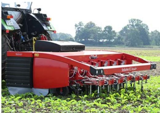
L'IC-Weeder IA permet de désherber intégralement intra-rang et inter-rang en un seul passage. La détection des rangs et des plantes est faite par caméra. Le pack IA (Intelligence Artificielle) permet la reconnaissance spécifique des betteraves pour une qualité de binage optimale jusqu'à
