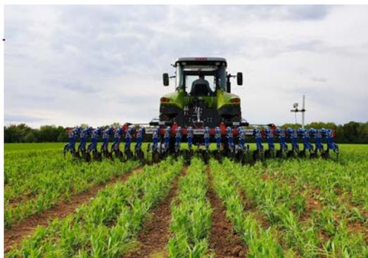
Bineuse sur poutre Argus facilitant les réglages fins des éléments au plus près des rangs. Interface de guidage par caméra avec translateur. De multiples configurations ou options sont possibles : disques, lames lieuvre, doigts Kress (moulinet sur le rang), lame plate, dent en patte d'oie...
