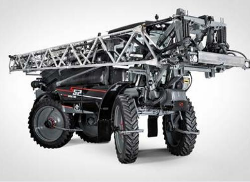
L'automoteur Spectre est équipé de la solution de pulvérisation ultra-localisée Sniper qui détecte la cible grâce à l'analyse d'images : la forme, la texture et enfin la couleur sont analysées afin de ne pulvériser que la cible souhaitée (détection Green on Brown ou Green on Green). Des modèles
