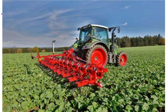
La Transformer VF est composée d'un châssis robuste et compact lui permettant d'être très maniable mais également de pouvoir porter des éléments de binage lourd et largement dimensionnés. Le poids de l'élément (60 kg) assure l'entrure des socs en terre afin d'avoir une qualité de découpe optimale.
