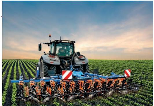
Amazone France distribue dorénavant les bineuses Schmotzer. La gamme permet un binage dès 12,5 cm d'inter-rangs. Venterra, ici présentée en 12 rangs, inter-rangs 45 ou 50 cm, dispose d'un châssis double poutre compact, profilé en H. L'interface AV5 permet de guider la bineuse via 1 ou 2 caméra(s).
